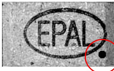
Fig.: 12: Left corner block „repaired“
