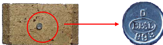
Abb.: 16 u. 17: Reparaturkennzeichnungsnagel
